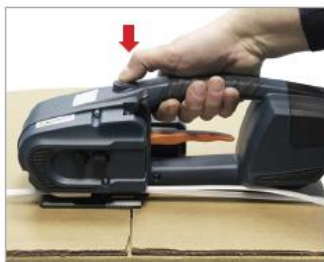
Mise sous tension du feuillard
