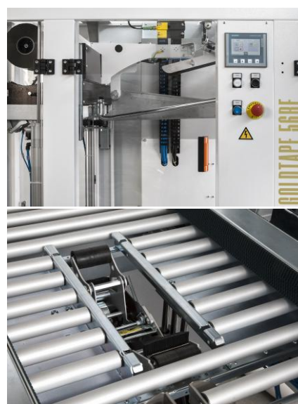
TÊTE DE SCOTCHAGE INFÉRIEURE ESCAMOTABLE POUR PASSAGE DE BOÎTES DÉJÀ SCOTCHÉES
